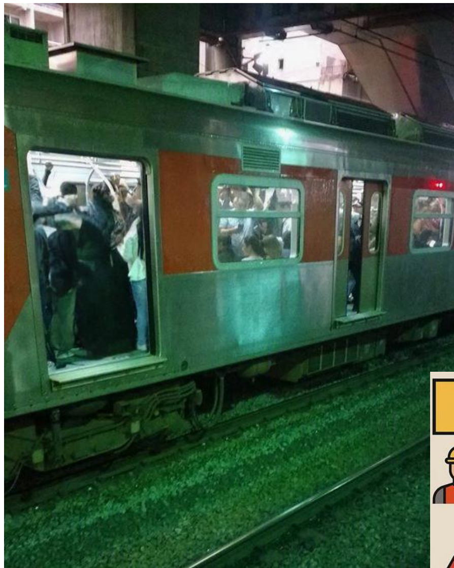
Figura 01: Foto real de ocorrência de abertura incorreta de portas fora da região de plataforma.
