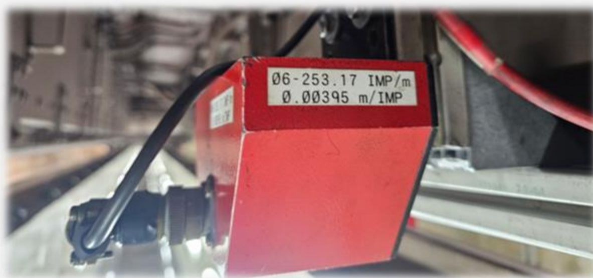
Sensor de radar doppler, fornece distancia e tempo.
