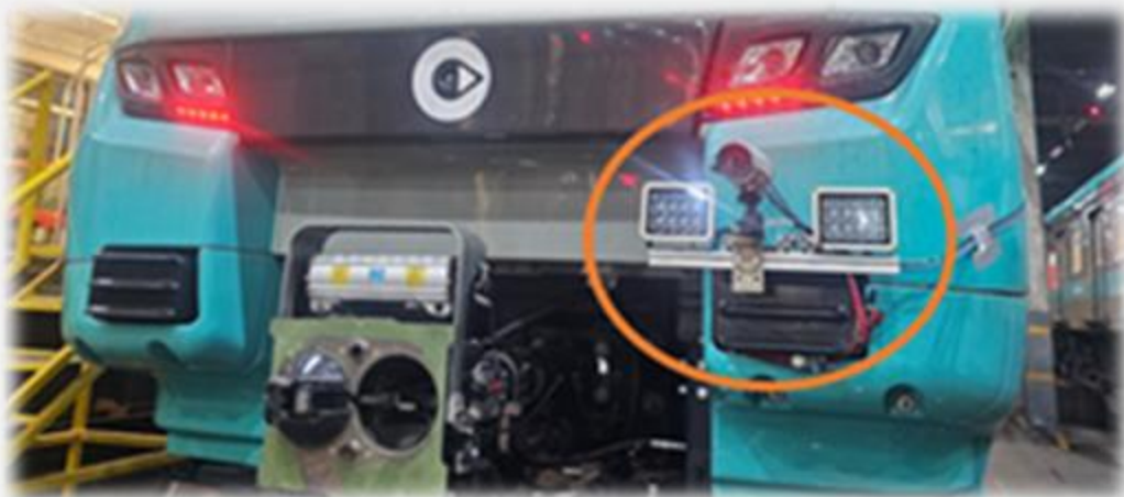
Câmera com holofotes infravermelhos na frente do trem
