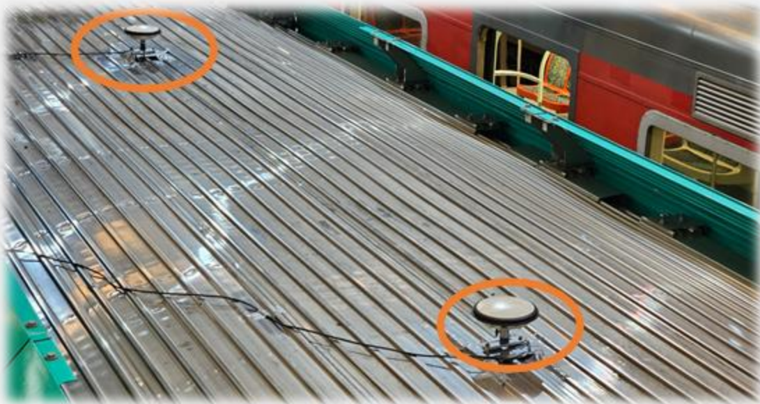
Antenas GPS no teto do veículo
