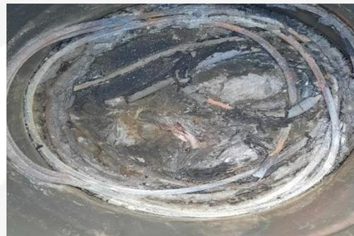
Marcação e de fácil visualização mesmo após o cabo ser submetido a alta temperatura. Cabe ressaltar que para visualização e identificação faz-se necessário um ambiente escuro (Blecaute).
