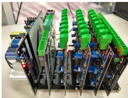
**Figura 5 - Coletor de dados MDL utilizado para receber, processar e enviar os dados provenientes do sensor de corrente**
