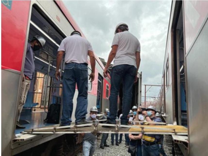
Figura 2 - Protótipo – Prancha de Transbordo de Passageiros.
