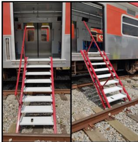
Figura 5 - Prancha-Escada em modo escada.
