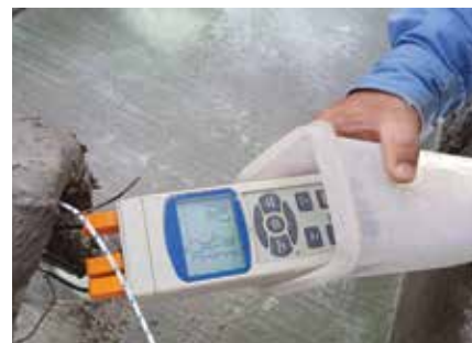
Figura 4 - Acompanhamento da temperatura de cura da viga-guia
