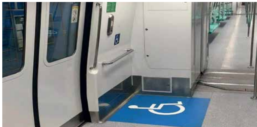
Figura 2 - Espaço demarcado para cadeirantes com intercomunicador nos trens do metrô de Singapura (SMRT)
