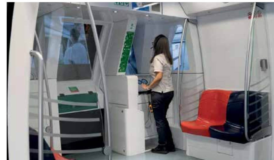
Figura 3 - Mockup do simulador com portas de passageiros da Lander desenvolvido em conjunto com o metrô de Singapura (SMRT)
