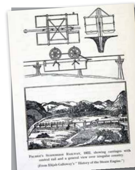
Figura 1 - Sistema de Monorail proposto por Palmer - Imagem extraída da "Publicação Description of a Railway on a New Principle" - the study of Henry R. Palmer, London, 1823
