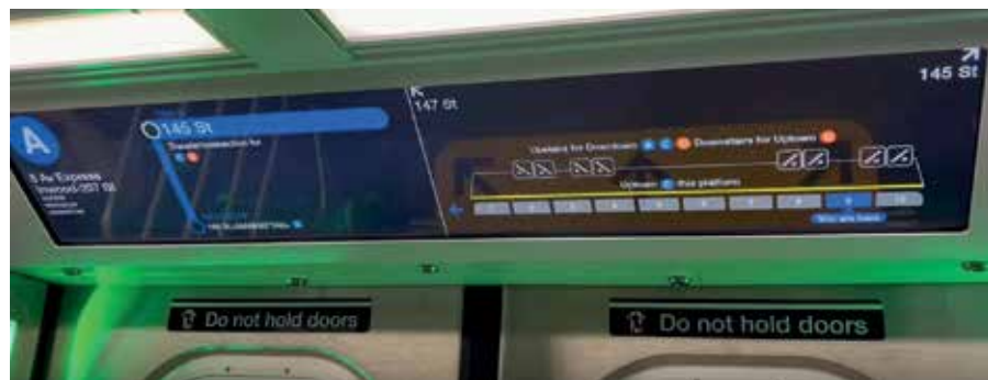
Figura 4 - Conceito FIND aplicado no mapa dinâmico de linha para a frota R211 do metrô da cidade de Nova Iorque (MTA)
