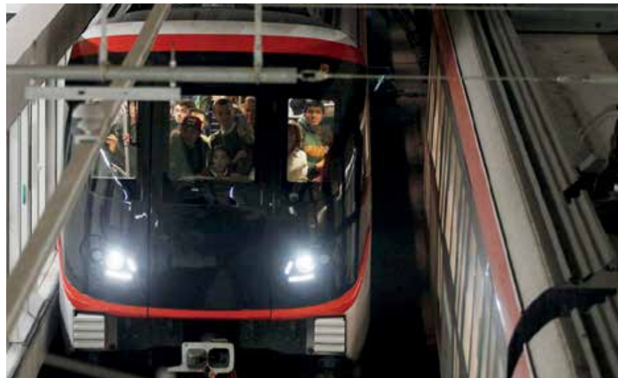
PSD em sincronismo com trem do Metrô da Linha 3 de Santiago/Chile
