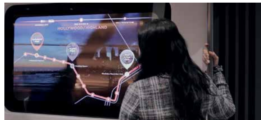
Figura 5 - Exemplo de telas semitransparentes em OLED aplicadas em janelas de trens
