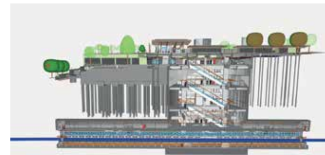
Figura 1 - Modelo BIM Federado da Estação Itapegica, uma das 36 unidades construtivas da Linha 19-Celeste
