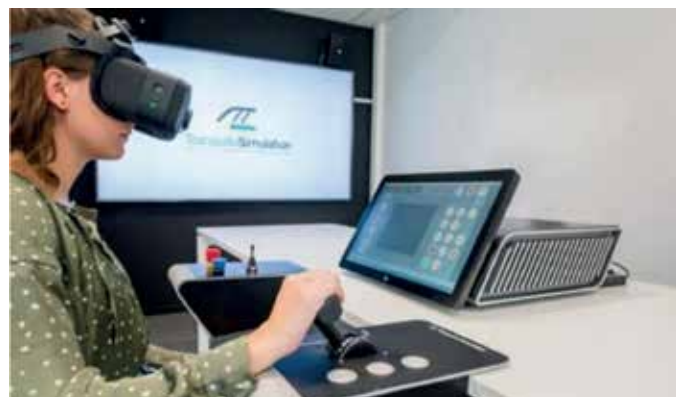
Figura 7 - Simulador Nano compacto com realidade mista da Transurb para treinamento de operadores de VLT
