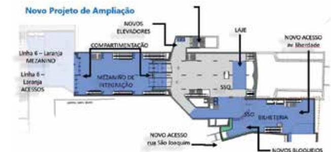
Figura 2 - Novo projeto de ampliação
