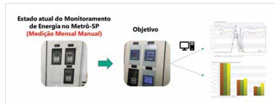
Figura 2 - Projeto de Monitoramento de Energia e os ganhos junto ao Sistema Monitoramento de Ativos (SMA) interligando os Multimeditores de Energia
