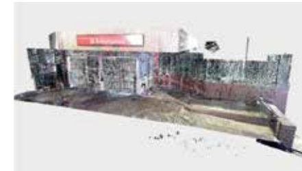
Figura 7 - Perspectiva parcial de nuvem de pontos de escaneamento 3D a laser do acesso à Estação Anhangabaú;
