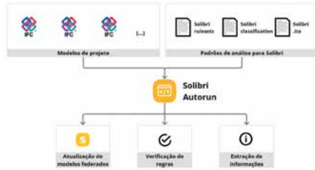
Figura 10 - Processo de automatização de verificação de regras e extração de informações via Solibri
