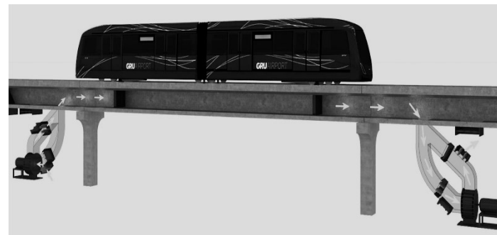
Figura 9. Sistema de propulsão patenteado pela empresa Aeromovel Brasil [4]
