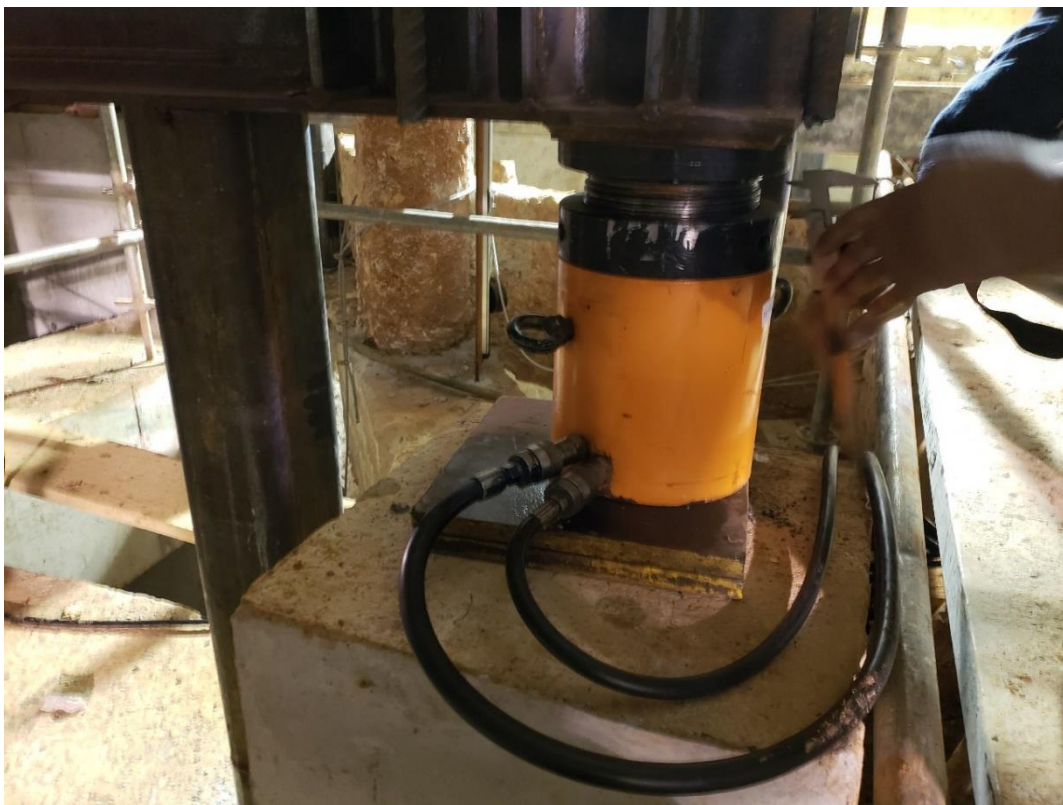
Figura 13 - Detalhe do macaco hidráulico utilizado para o carregamento da estrutura.
