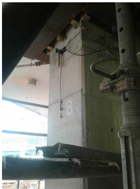
Figura 11 - Medidor de deformação utilizado durante a transferência de carga.
