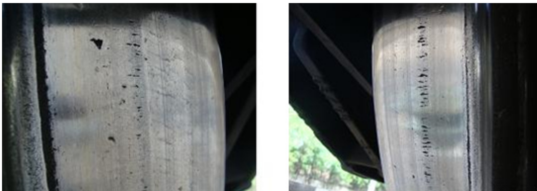
Figura 8 – Shelling – Escamação da superfície de rolamento (Fotos do autor)
