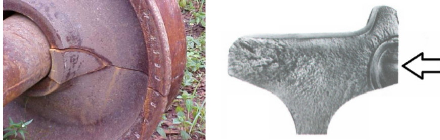
Figura 10 – Roda fraturada com a origem da trinca na marcação a quente na lateral do aro (GARRIDO, 2004 e MINICUCCI, 2011)
