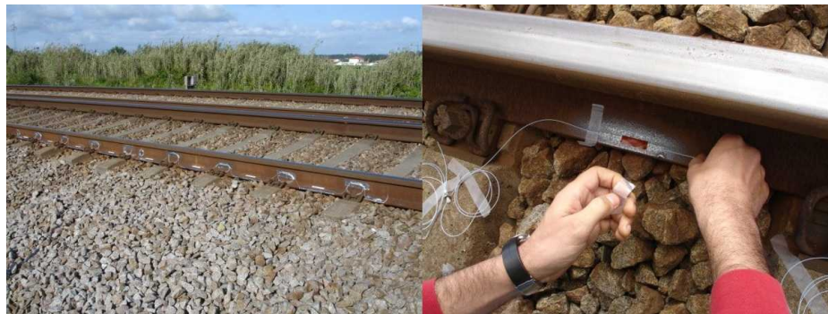
Figura 16 – Detector de carga de impacto de rodas utilizando sensor de Bragg (BARBOSA, 2009)
