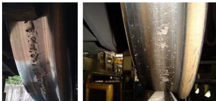
Figura 7 – Spalling em todo o perímetro da superfície de rolamento (Fotos do autor)
