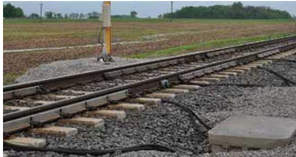
Figura 12 – Detector de carga de impacto de rodas utilizando extensômetros (Strain gauges- LBFOSTER, Salient Systems, 2017)
