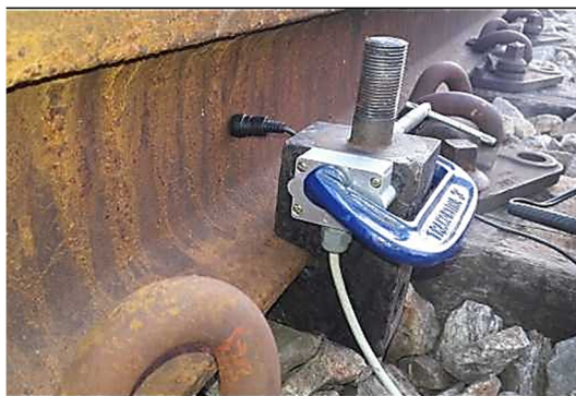
Figura 20 - Instrumentação do microfone no trilho (Foto do autor)
