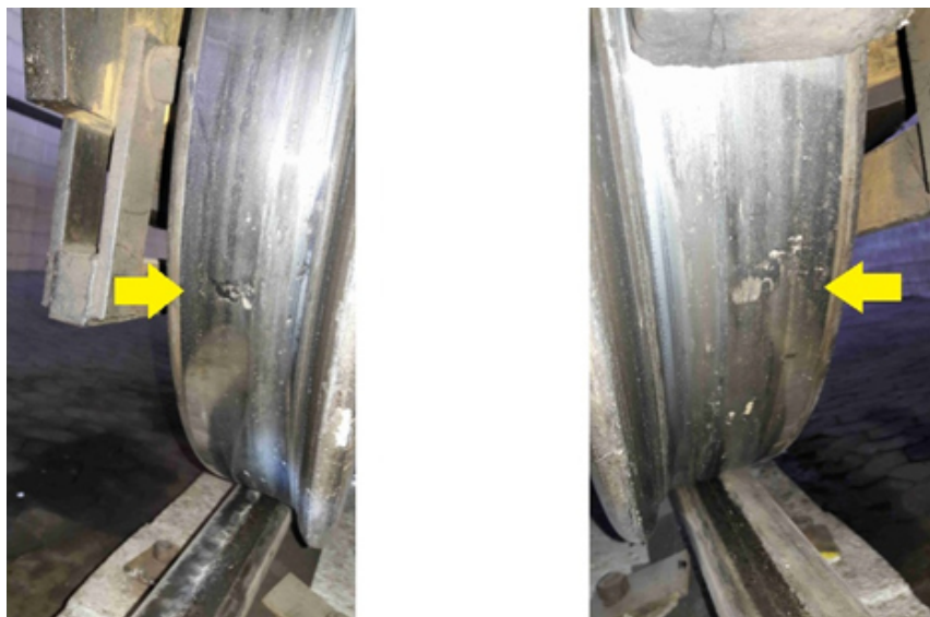
Figura 24 - Calos constatados nas rodas do último rodeiro da carreta acoplada ao VF 002 (Fotos do autor)
