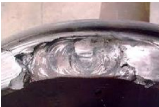
Figura 9 – Shattered rim – aro da roda despedaçado (MINICUCCI, 2011)
