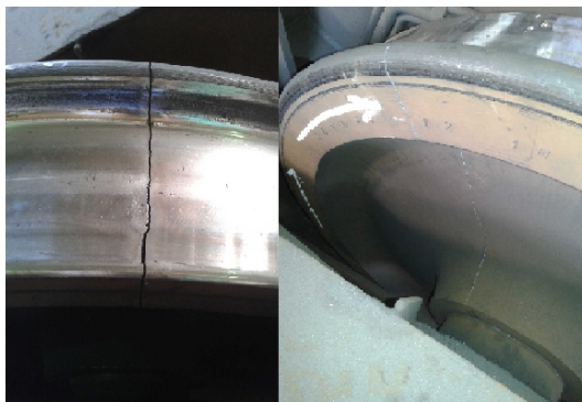
Figura 11 – Fratura radial da roda (Fotos do autor)
