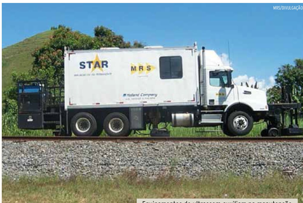
Equipamentos de ultrassom auxiliam na manutenção
